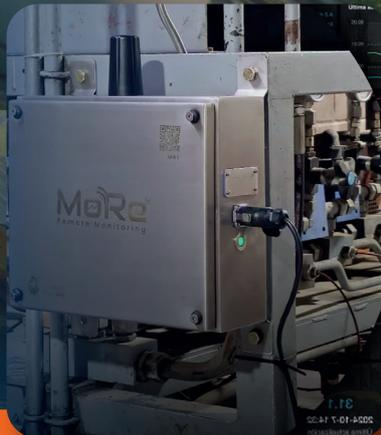
Equipo de monitoreo remoto de condición de aceite lubricante para un molino
