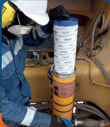
Montaje de un sistema de filtración de alta eficiencia
