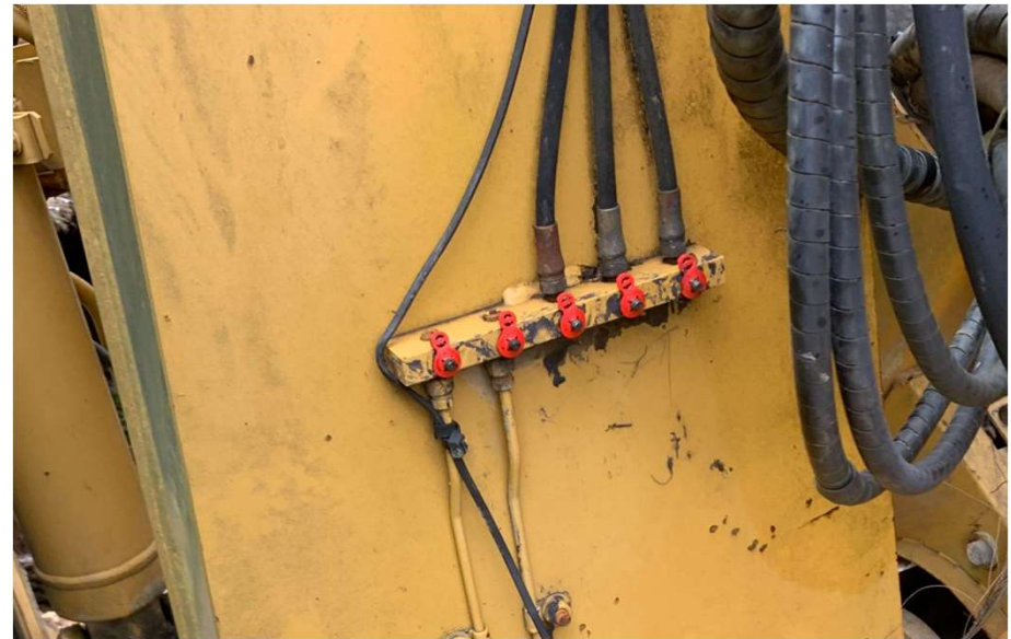
Seguimiento manual del punto de engrase de la excavadora
